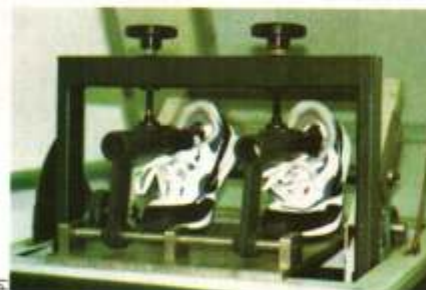
Teste de durabilidade: 500 mil flexões
